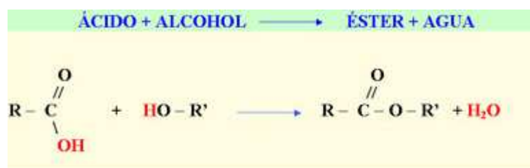
Figura 4.9. Reacción de esterificación. Fuente: http://grupoqog6.pbworks.com/w/page/16303274/Q u%C3%A9%20es%20el%20Biodiesel
